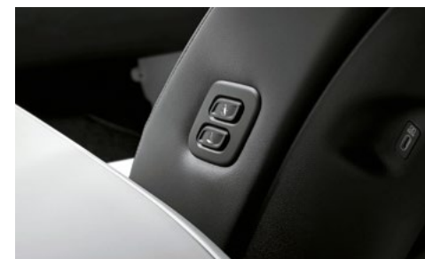
Walk-in Device - przyciski do sterowania fotel pasażera np. z pozycji kierowcy lub z 2. rzędu. Standard
