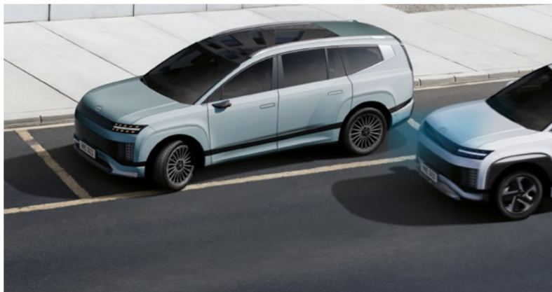
BCA (Blind-Spot Collision-Avoidance Assist) Monitoruje martwe pole i interweniuje, jeśli kierowca zaczyna zmieniać pas, a inny pojazd znajduje się w niebezpiecznej odległości.
